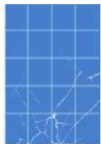
Daño de transporte
